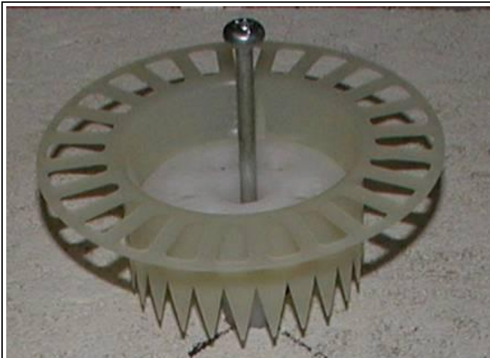
Abb. A1.2-6: Aufbau des geklebten + gedübelten WDVS mit Mineralwolle-Dämmplatten, hier mit versenkter Dübelung mit EJOT Dübelteller VT 2G \text{AE } 112,5 \text{ mm} (hier Probekörperherstellung – Winsogversuche). (Hinweis: Es wurde eine EPS-Rondelle verwendet, in Verbindung mit Mineralwolle-Dämmplatten werden in der praktischen Anwendung Rondellen aus Mineralwolle verwendet.)
