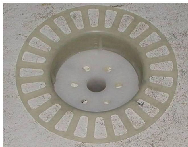
Abb. A1.2-6: Aufbau des geklebten + gedübelten WDVS mit Mineralwolle-Dämmplatten, hier mit versenkter Dübelung mit EJOT Dübelteller VT 2G \text{AE } 112,5 \text{ mm} (hier Probekörperherstellung – Winsogversuche). (Hinweis: Es wurde eine EPS-Rondelle verwendet, in Verbindung mit Mineralwolle-Dämmplatten werden in der praktischen Anwendung Rondellen aus Mineralwolle verwendet.)
